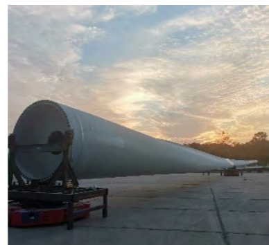
现叶片智能转运车安装方式
